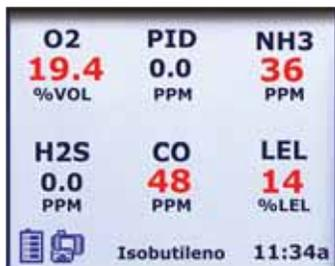
Numerais em vermelho realçado e uma luz de fundo piscando mostram condições de alarme.
